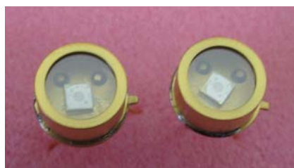
図：小出が開発したショットキーダイオード型ダイヤモンド深紫外線センサ模式図および表面写真(左)とパッケージ素子の写真(右)
